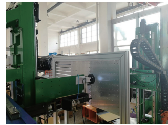
图8 铆接试验平台
